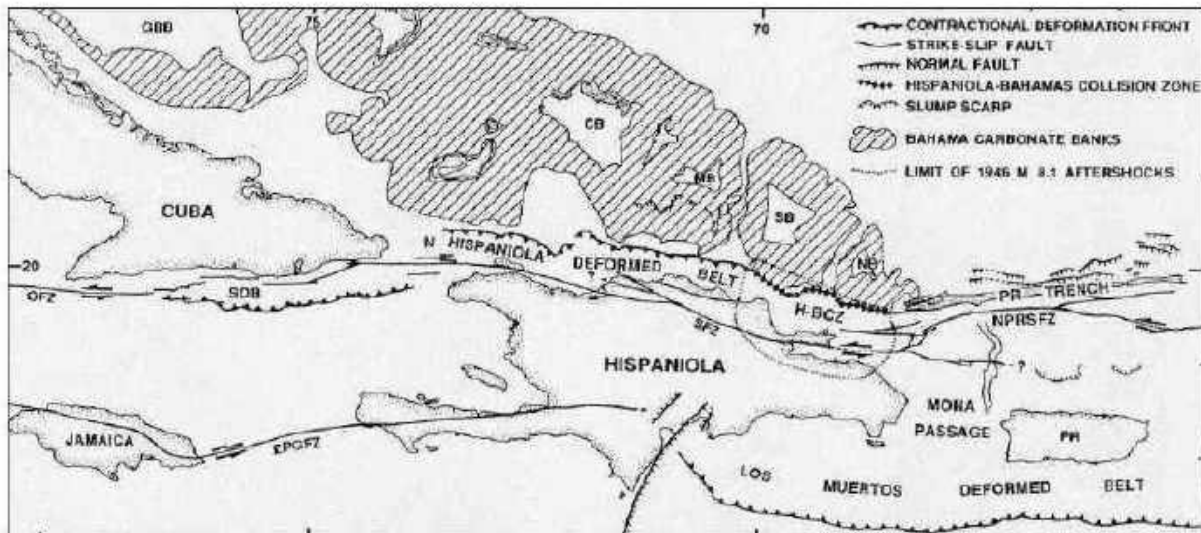
Fig. 4 Posición de La Isla de La Española y relación de los principales cizallamientos sinistros con la falla transformante Polochic/Caimán. Fuente: (Dolan J.F. et al, 1998).
